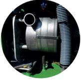
Réservoir de récupération avec trappe de nettoyage
