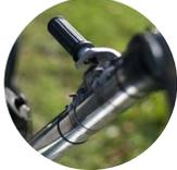
Longue canne équipée d'une poignée de commandes pour l'aspiration et l'aspersion
